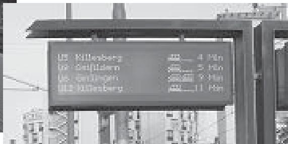
今後到着する電車の情報を表示している電光掲示板（Vaihingen 駅Uバーンホーム）。右の写真は、表示部分の拡大で、左から路線番号、行き先、車両の数とホーム上の到着位置、到着するまでの時間を表示している。1行目の表示は、U 5路線・Killesberg 行きが、ホーム前方に1両の車両で4分後に到着することを示している。
